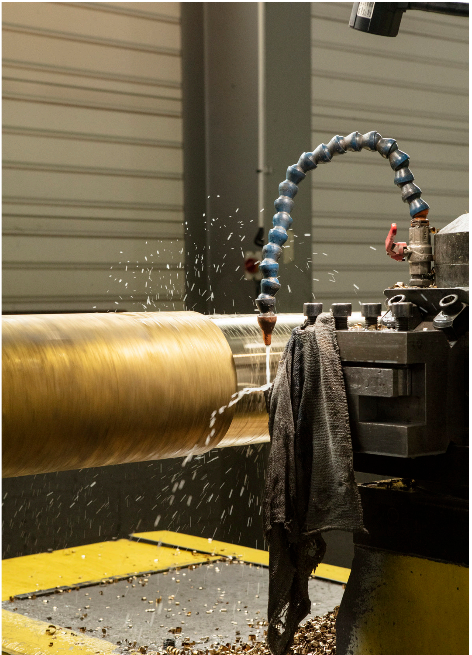
Usinage des tubes en bronze-aluminium dans les ateliers de LBI à Amneville
